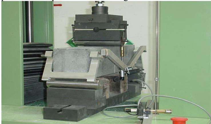
*Figure III. 15: Dispositif expérimental, bâti, machine de flexion*
