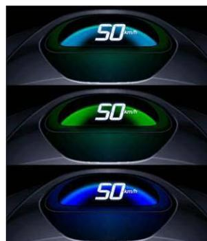
*Figure 39* : A gauche, indicateur numérique de consommation instantanée, parfois accompagné d'une barre de progression pour visualiser schématiquement la consommation. A droite, indicateur d'éco-performance avec changement de couleur, qui équipe les véhicules hybrides Honda Insight.
