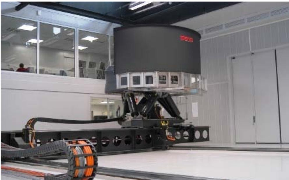
*Figure 3* : Aperçu du simulateur *Ultimate* du CTS Renault. On distingue les rails, ainsi que l'hexapode et l'écran cylindrique derrière lequel se trouve le cockpit du véhicule. Derrière la partie vitrée en hauteur se trouve le poste de commande du simulateur
