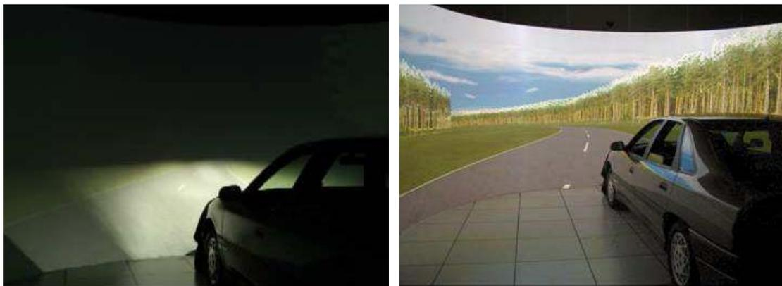
**Figure 2** : Aperçu du simulateur éclairage du CTS Renault. A gauche un aperçu d'une conduite de nuit. On peut voir le faisceau lumineux projeté par les optiques du véhicule. A droite, un aperçu d'une conduite de jour permet de se rendre compte de la qualité de l'immersion grâce au champ de vision très large.
