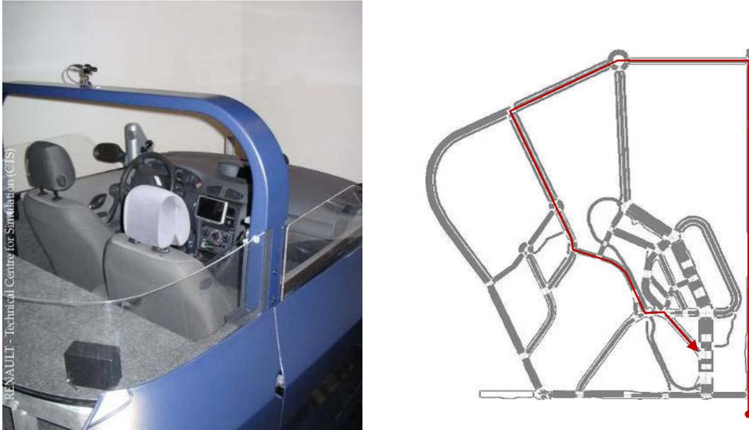
**Figure 42** : A gauche, vue du cockpit du simulateur Cards. Sur la console centrale, on peut voir l'écran d'assistance visuelle à l'éco-conduite. A droite, vue de dessus de l'environnement routier de la simulation, avec en rouge le trajet à suivre par les sujets. Le trajet prend tour la tour la forme de routes droites suffisamment longues pour une accélération complète jusqu'à 50km/h, mais également des ronds-points, ainsi que des virages incurvés ou à angle droit.
