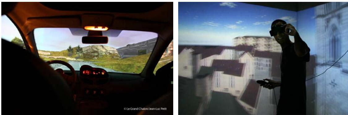
*Figure 1* : A gauche, aperçu de l'intérieur du simulateur SAM. Sur cette photo, on peut s'apercevoir de la qualité immersive du simulateur. A droite, aperçu du cube immersif MoVe. L'utilisateur, chaussé de lunettes stéréoscopiques actives, voit les images qui l'entourent en 3D.
