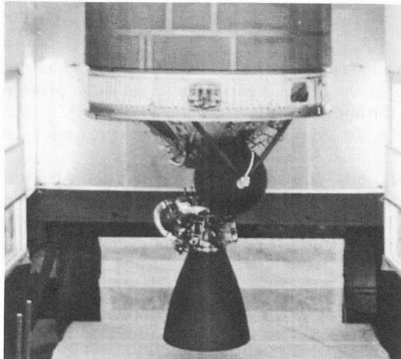
Fig. 7. — Divergent de moteur fusée en C/SiC (Programme Ariane).
