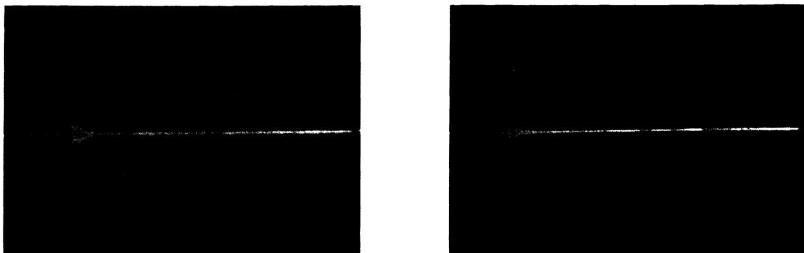
Fig. 7. — Impulsion de l'onde d'arête proche de  $\Gamma_2$  sur un échantillon de quartz de coupe  $x$ , fréquence 4 MHz, à droite avec une pression à l'arête.
