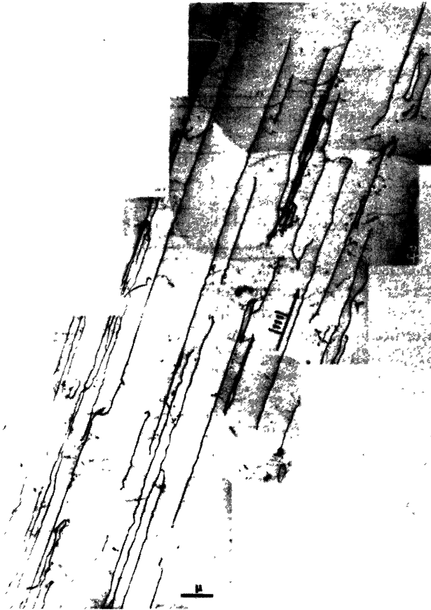
Fig. 4. — Dislocations rigides dans le Nb déformé en traction à 50 K [21a].
