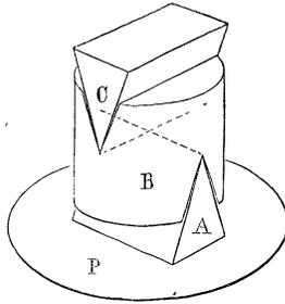
rizontale fixe P; le cylindre métallique B porte sur ses deux bases deux entailles en biseau à angle droit l'une sur l'autre. Par la première, la pièce B repose sur l'arête horizontale du couteau A; dans la seconde, repose l'arête horizontale du couteau C, avec assez de jeu pour permettre des oscillations d'une certaine amplitude. La tige du pendule est fixée au couteau C par quatre tiges qui traversent la plaque P par des ouvertures suffisantes pour le jeu oscillatoire.
