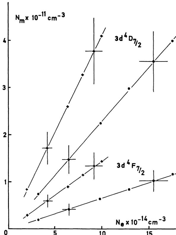
FIG. 4. — Densité des métastables ioniques pour les niveaux  $3d\ ^4D_{7/2}$  et  $3d\ ^4F_{7/2}$  en fonction de la densité électronique. Pression de remplissage d'argon : (+)  $5 \times 10^{-2}$  torr, (•)  $10^{-1}$  torr.
