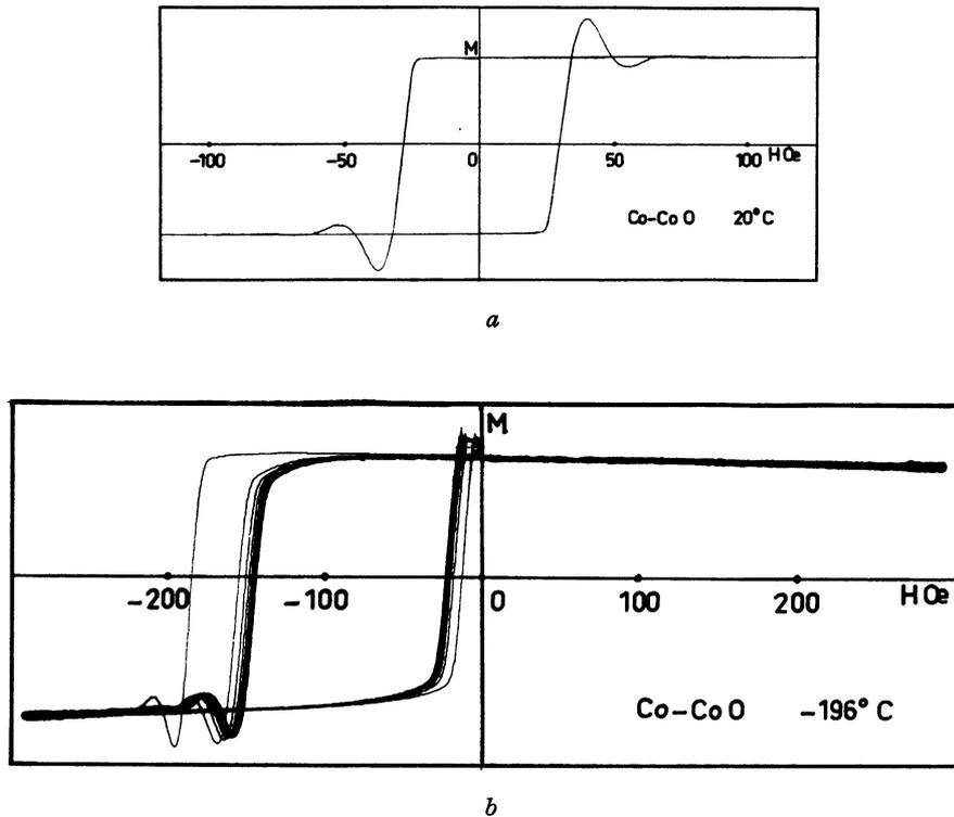
FIG. 3. — Cycles d'hystérésis de couches Co-CoO relevées à  $5 \times 10^{-3}$  Hz.
