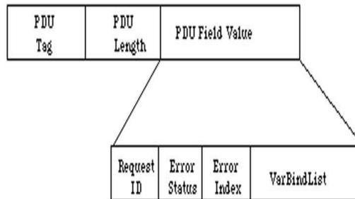
FIG. 6.4 – Le premier format PDU de SNMPv1
