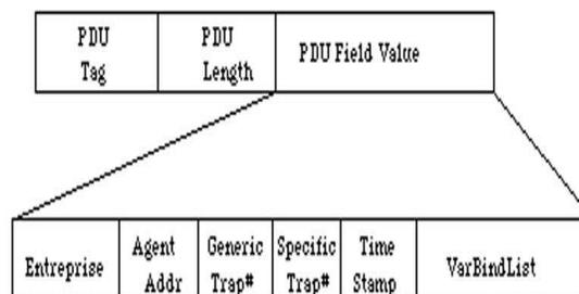
FIG. 6.5 – Le format Trap de SNMPv1
