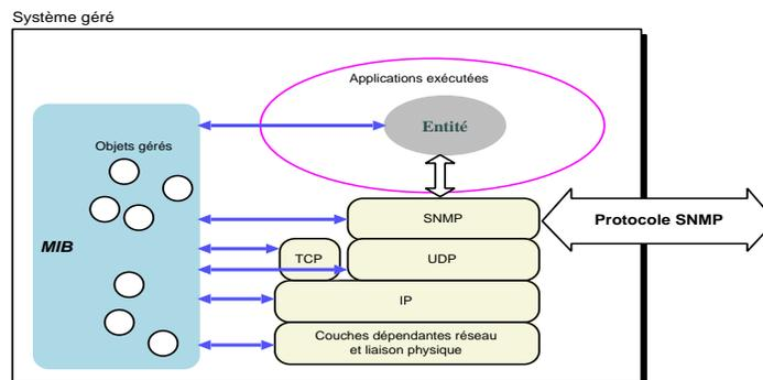
FIG. 6.2 – *Architecture de la gestion SNMP*
