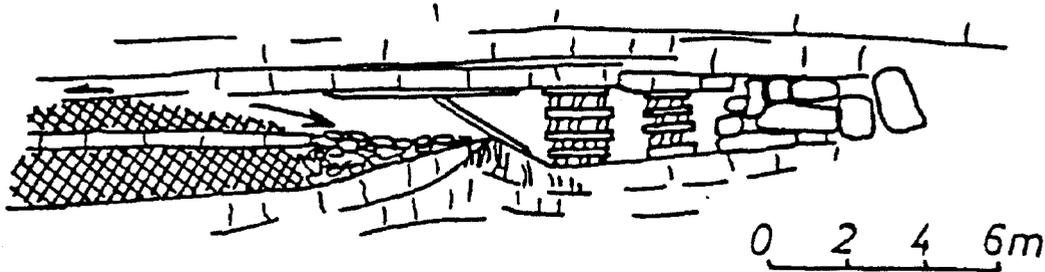
Fig. 1 : Description schématique d'un coup de terrain
