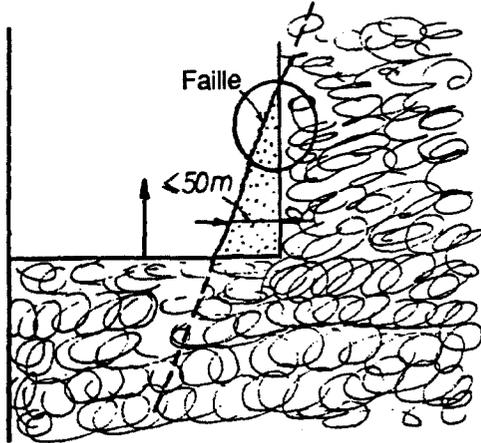
Fig. 2 : Exemple de géométrie d'exploitation induisant des coups de terrains à mécanisme purement local.
