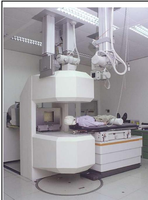
*Illustration 10: Système de TEP en ligne présent au GSI à Darmstadt en Allemagne. Les deux têtes de détecteurs sont placés en vis-à-vis*
