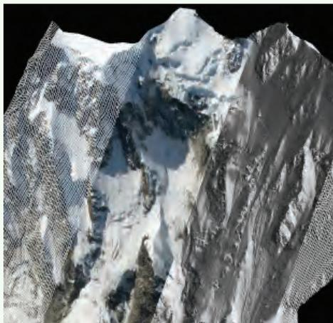
▲ Modèle 3D de la face Est du Mont Rose (Italie) pour le suivi d'éboulement de grande ampleur (Fischer et al. 2011). La face fait ~2000 m de dénivellation sur 1 km de large.
