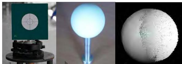
Figure 15 - Types de cibles employées avec le scanner Trimble GX ; de gauche à droite : cible plane ; sphère ; sphère modélisée sur la base du nuage de points la couvrant.
