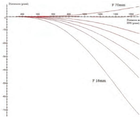
Figure 4 - Distorsion d'un objectif Minolta 18-70.
