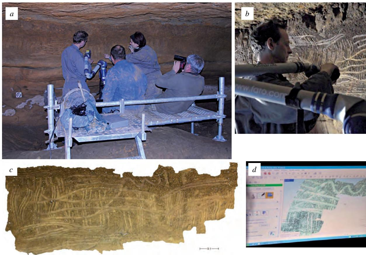
Figure 3 - Test de numérisation d'un panneau orné du secteur 13 par le scanner laser Scan Arm (FARO) ;
