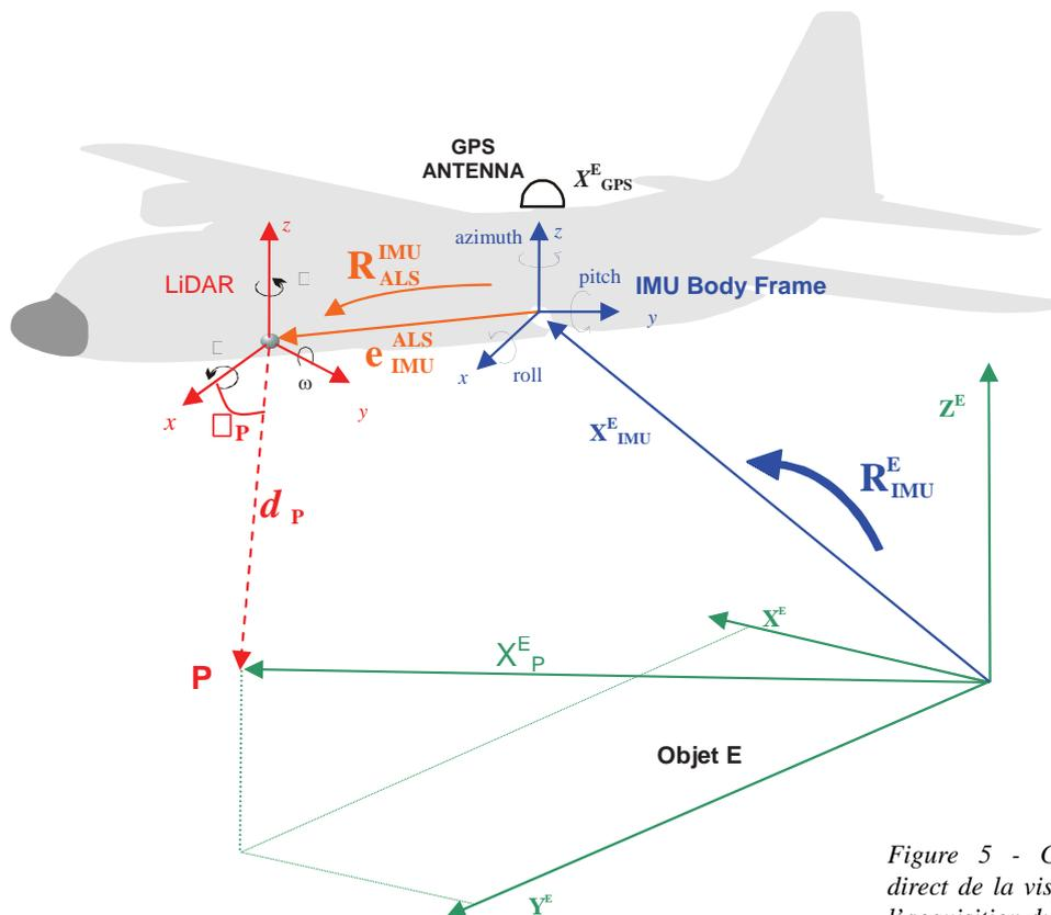
Figure 5 - Géoréférencement direct de la visée laser pendant l'acquisition du point.
