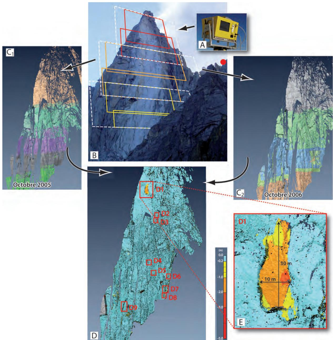
Figure 1 - Acquisition et traitement des données 3D à haute résolution.
