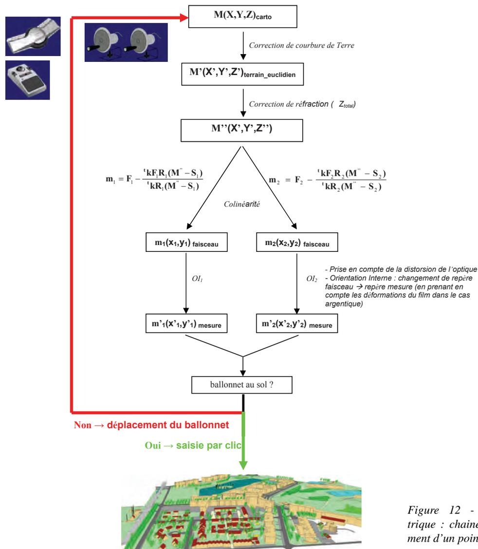
Figure 12 - Restitution photogrammétrique : chaîne de calcul lors de l'ajustement d'un point au sol.
