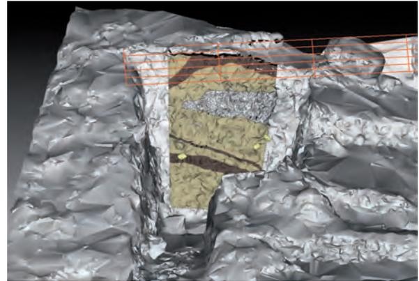
Figure 4 - Le texturage des coupes permet de générer des polygones 3D sur le modèle et à partir du relevé des fouilleurs. Traitement réalisé sur 3DReshaper.
