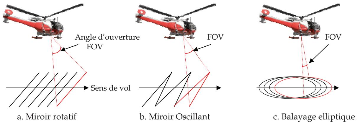
Figure 2 - Différents types de balayage du scanner. La partie en rouge montre la trace effectuée lors d'un balayage.
