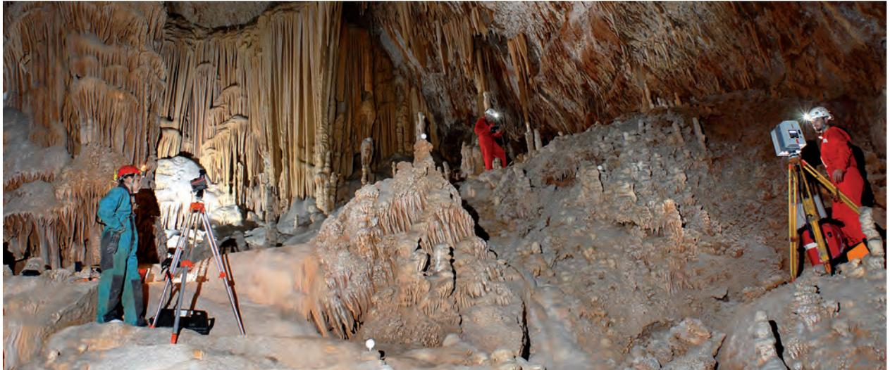
Photo 2 - Acquisition lasergrammétrique du modèle 3D des spéléothèmes dans la grotte de Jeita. Un scanner HDS 6000 est ici mis en œuvre (à droite). Des sphères servent à la consolidation des scènes et un référencement local est réalisé avec un compas électronique couplé à un distance-mètre (à gauche) (Photo Stéphane Jaillet).
