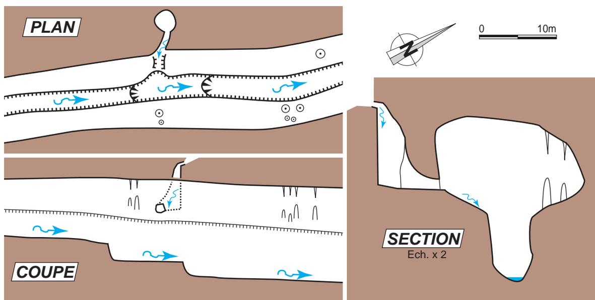
Figure 1 - Représentation topographique classique en plan coupe et section d'un drain spéléologique.
