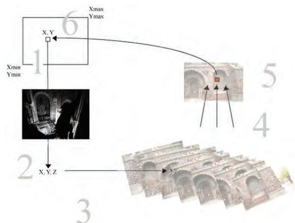
Figure 13 - Processus de calcul d'une orthophoto.
