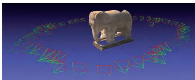
en quantifiant la ressemblance conjointe de l'ensemble de ses projections sur plusieurs images (typiquement 3 à 9) ; on augmente ainsi fortement la fiabilité des appariement puisque la probabilité que les points se ressemblent simultanément dans toutes les images sans être réellement homologues diminue sensiblement quand on utilise 3 ou 4 images ; l'augmentation du nombre de mesures pour un point, permet aussi d'améliorer la précision des mesures.
