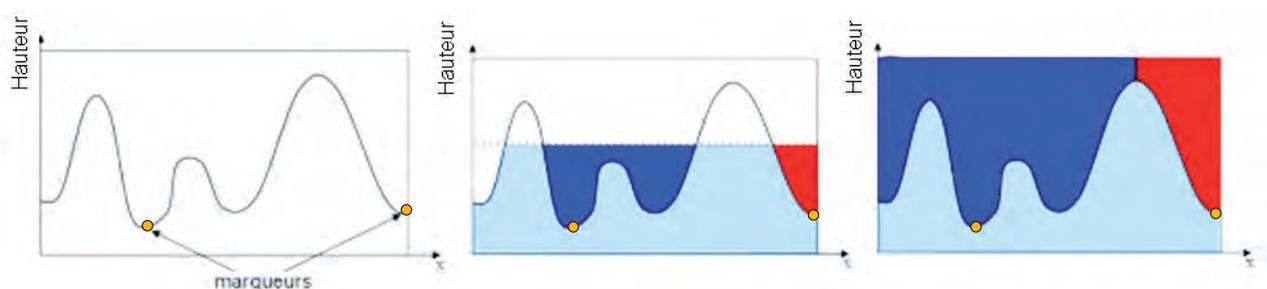
Figure 6 - Le principe de LPE avec marqueurs. Les minima locaux sont choisis par l'opérateur. Ils sont indiqués par les points orange.
