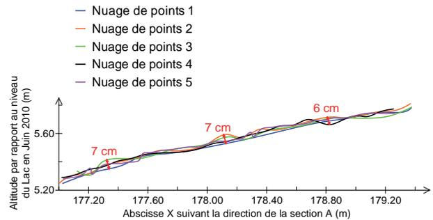
Figure 10 - Graphique représentant l'ensemble des nuages de points du modèle de juin 2010 après consolidation (voir Figure 8 pour le système de coordonnées retenu). Sur cette section, les moraines centrales présentent des écarts entre nuages de points inférieurs à 7 cm. Ces écarts correspondent à ceux représentés par l'outil de comparaison du Best-Fit Figure 7.
