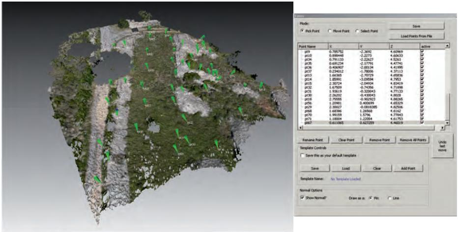
Identification des cibles dans les nuages de points et extraction des coordonnées associées dans le référentiel relatif à la reconstruction 3D (MeshLab)
