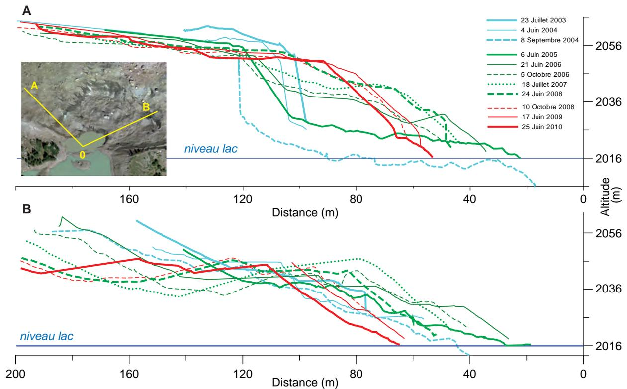
Figure 9 - Profils topographiques de la falaise de glace du lac du Miage entre juillet 2003 et juin 2010. Le niveau du lac indiqué (2 016 m) correspond à sa cote maximale, non atteinte depuis septembre 2004.
