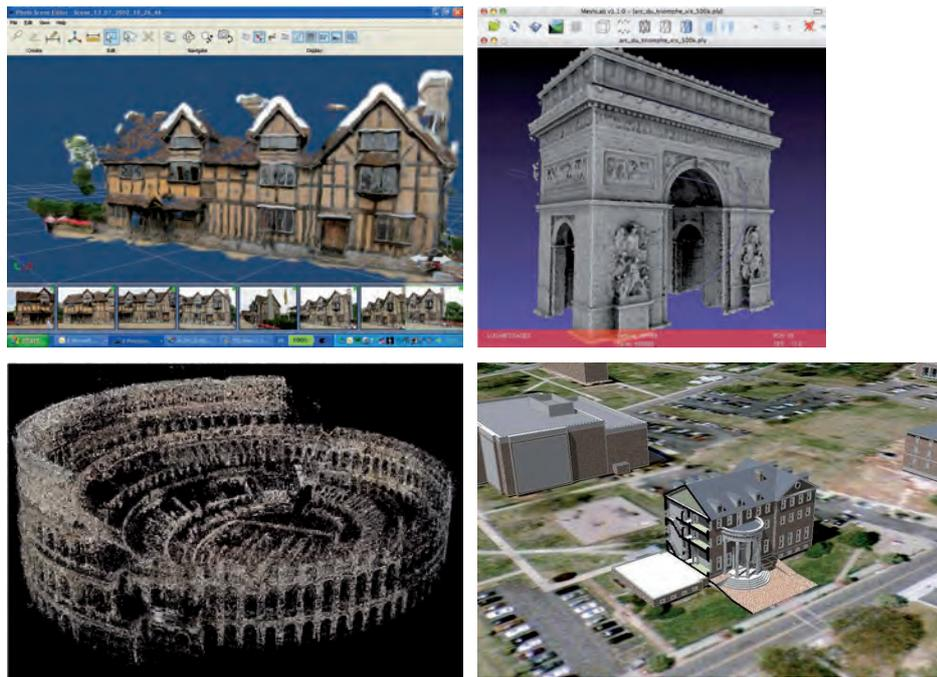
Figure 1 - Quelques exemples de modélisation 3D réalisées à partir de photos en utilisant des services ou logiciels gratuits : service Photofly (autodesk), service Arc3D et logiciels Bundler-PMVS. En bas à droite : modélisation avec google sketch-up.
