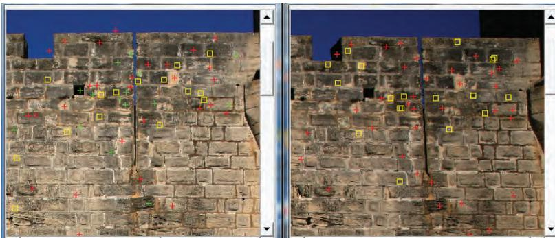
Figure 10 - Points de liaison automatiques. Les points en jaune sont faux.
