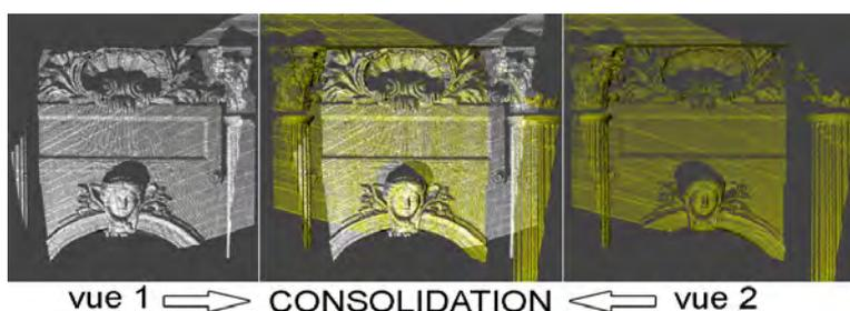
Figure 17 - Exemple de consolidation de deux nuages (Fuchs, 2006).
