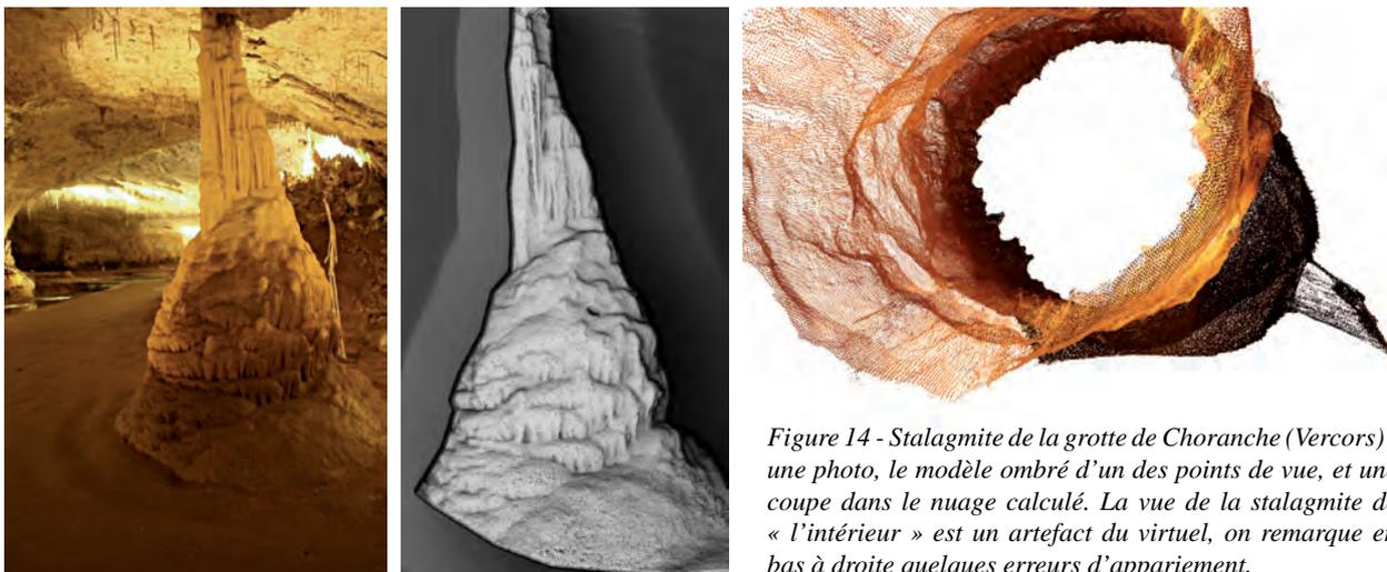
Figure 14 - Stalagmite de la grotte de Choranche (Vercors) : une photo, le modèle ombré d'un des points de vue, et une coupe dans le nuage calculé. La vue de la stalagmite de « l'intérieur » est un artefact du virtuel, on remarque en bas à droite quelques erreurs d'appariement.
