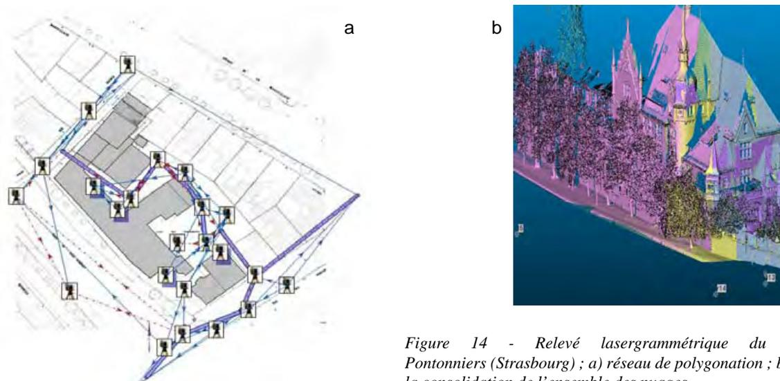
Figure 14 - Relevé lasergrammétrique du lycée des Pontonniers (Strasbourg) ; a) réseau de polygona-tion ; b) résultat de la consolidation de l'ensemble des nuages.
