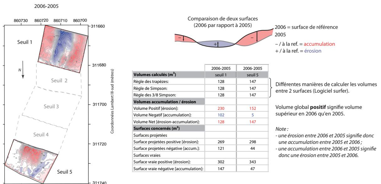
Figure 7 - Comparaisons diachroniques sur le site du torrent de la Lampe entre 2005, 2006, 2007 et 2008 : a) états successifs ; b) états comparatifs ; c) estimation des volumes.
