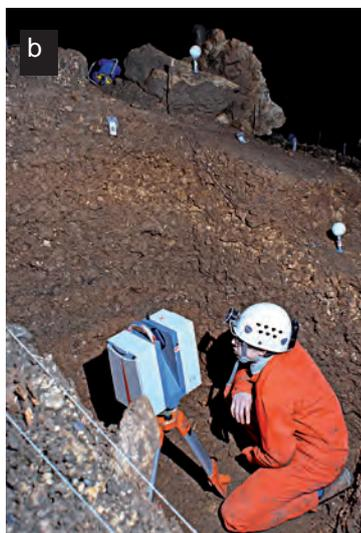
Photos 2a et 2b - Mise en œuvre de scanner 3D longue et courte portée ; a) le lidar Leica HDS6000 en bas du cône pour un scan du versant ; b) au cœur de la fouille pour une vue de détail. Les sphères servent à la consolidation des différentes positions acquises. Photos Stéphane Jaillet.
