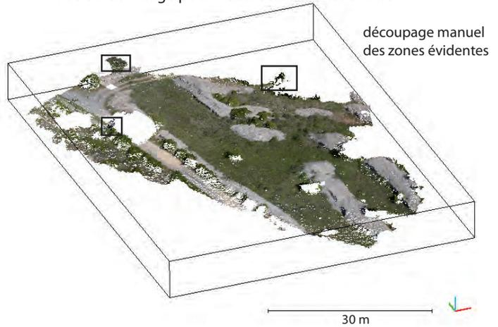
Filtrage du nuage de points 3D - séparation des points du sol et du sur-sol par filtres automatiques
