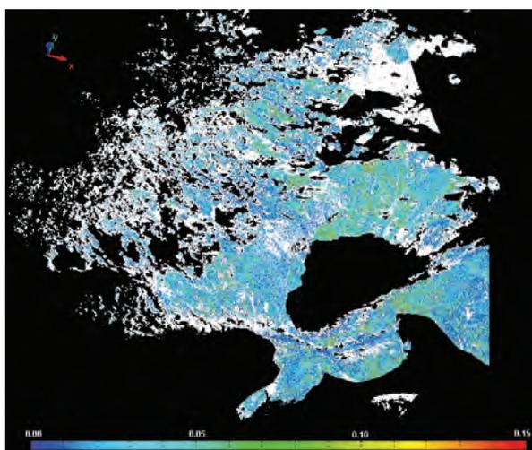
Figure 7 - Carte d'erreur sur la scène du lac du Miage de juin 2010 à l'issue du *Best-Fit* obtenue par l'outil de comparaison du *Best-Fit*. Globalement, les écarts absolus entre nuages sont inférieurs à 10 cm. Ils peuvent atteindre jusqu'à 15 cm dans les zones à fort recouvrements (6 nuages). En blanc, un seul nuage de points est présent.
