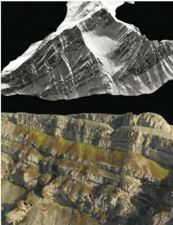
▲ *Modèle 3D texturé des parois de Mediumfjellet (Spiztberg), hauteur ~600 m. L'identification et le géoréférencement précis des différentes strates et plis, combinés à des mesures géophysiques, permettent de caler et valider un modèle structural 3D (Buckley et al. 2008).*
