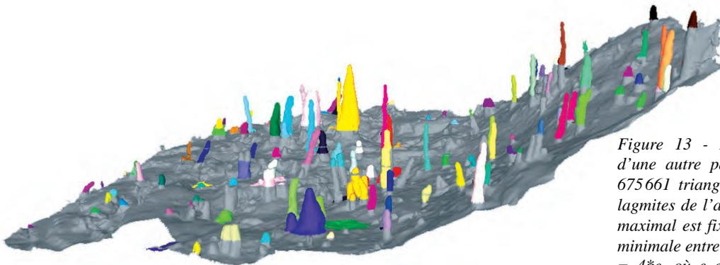
Figure 13 - Résultat d'identification d'une autre partie (341 229 points et 675 661 triangles) de la forêt des stalagmites de l'aven d'Orgnac ; le rayon maximal est fixé à 0,25 m. La distance minimale entre deux stalagmites  $d_{\min} \geq 4 * e$ , où  $e$  est la longueur moyenne d'une arête du modèle RTI de résolution 15 mm. Le temps d'exécution est de quelques minutes (entre 5 et 7 min).
