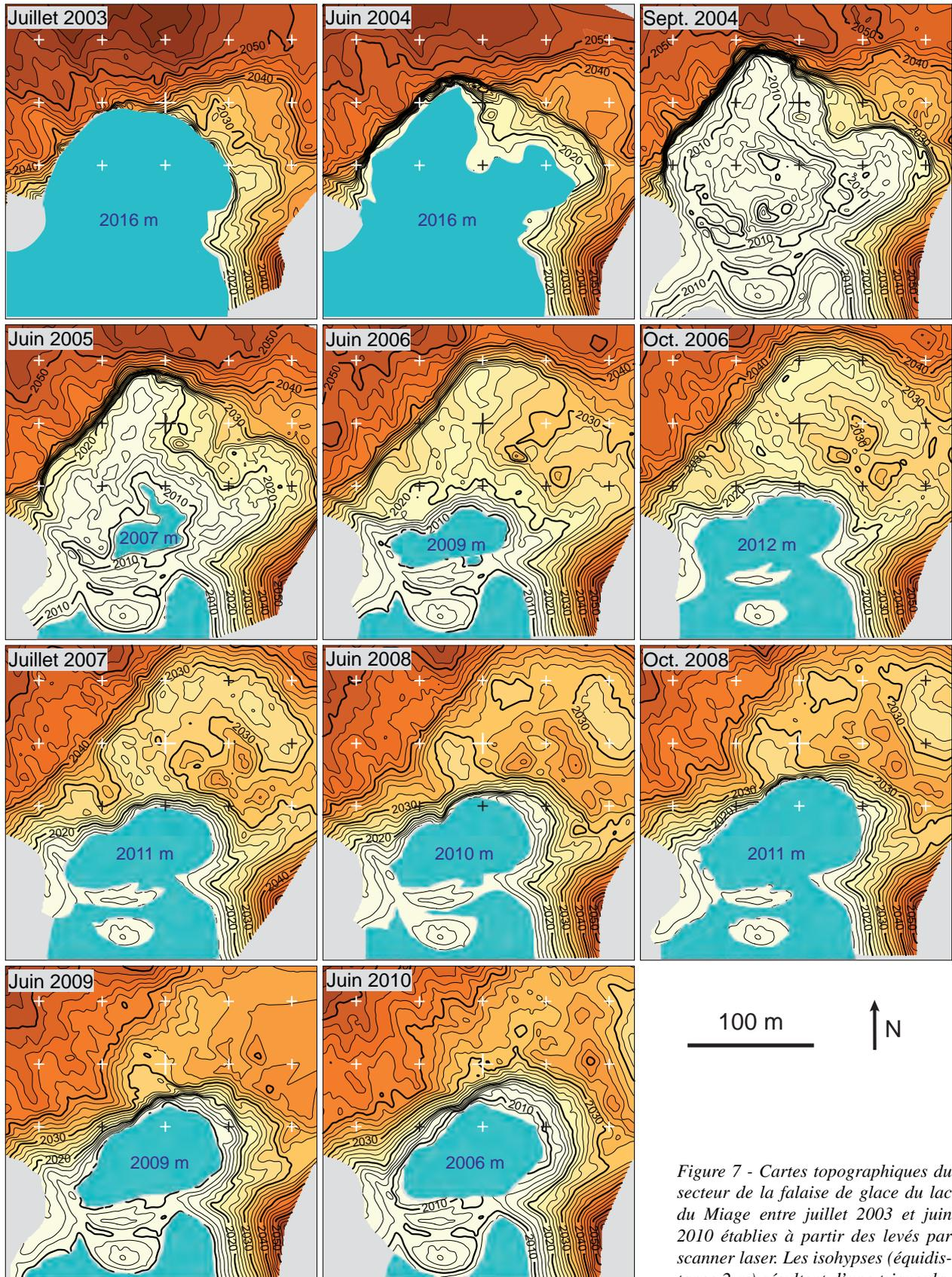
Figure 7 - Cartes topographiques du secteur de la falaise de glace du lac du Miage entre juillet 2003 et juin 2010 établies à partir des levés par scanner laser. Les isohypses (équidistance 2 m) résultent d'une triangulation Delaunay sous le logiciel Surfer
