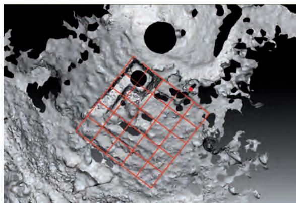
Figure 3 - Détail du modèle 3D (vue en plan) au droit de la fouille. Le carroyage et le point zéro de la fouille sont intégrés dans le modèle.
