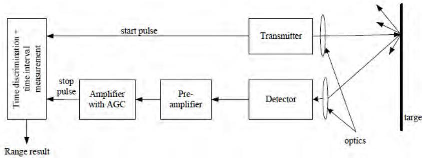
Figure 5 - Schéma des composantes d'un distancemètre à temps de vol (Reshetuyuk, 2009).
