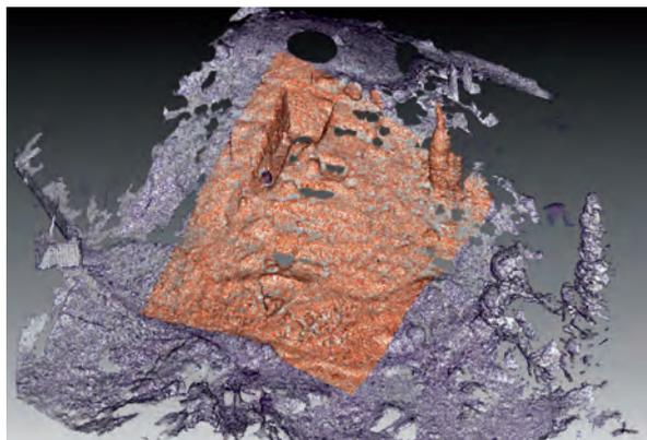
Figure 2 - Vue des nuages de points assemblés pour construire le modèle 3D
