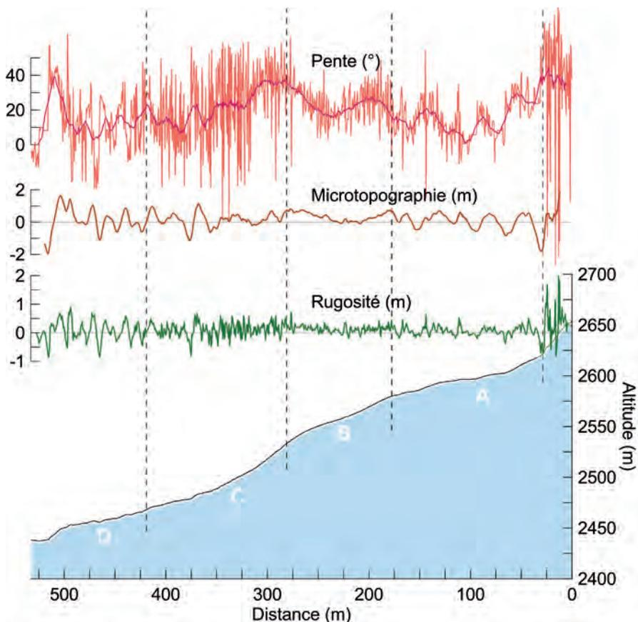
Figure 2 - Profil topographique en long du glacier rocheux de Laurichard et paramètres morphométriques issus du MNA haute résolution (LiDAR 2005). Les lettres correspondent aux sections décrites dans le texte.
