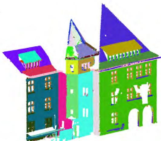
Figure 18 - Portion d'une façade de lycée des Pontonniers (Strasbourg) ; a) le nuage de points après prétraitements ; b) résultats de segmentation du nuage de points selon la primitive géométrique « plan » (Boulaassal *et al.*, 2007).
