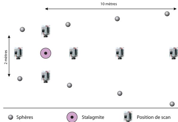
Figure 2 - Schéma du protocole expérimental de mesure mis en œuvre au laboratoire EDYTEM. Les sphères de référence sont disposées de façon à ne pas créer d'ambiguïté pour l'algorithme de calcul des solutions topographiques. La stalagmite est d'abord mesurée depuis toutes les positions à l'état brut puis scannée une seconde fois après application d'une peinture opacifiante.
