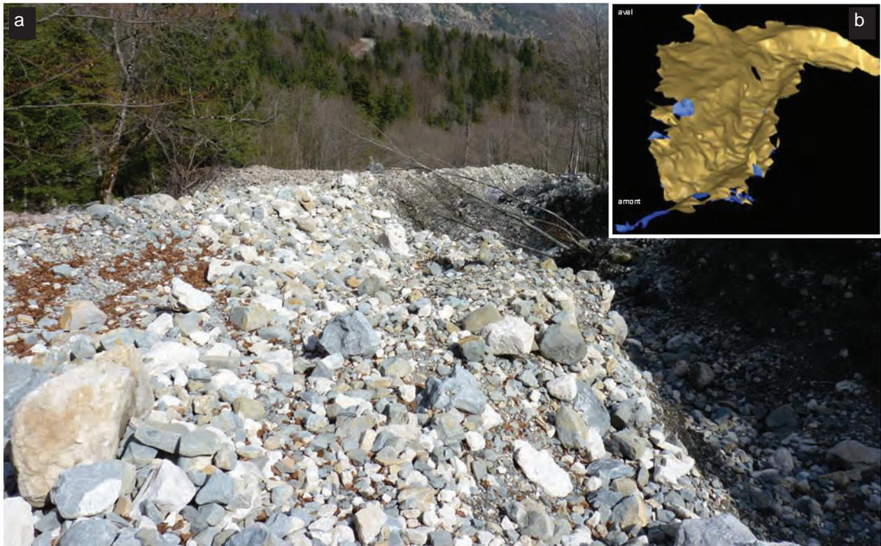
Figure 4 - Traitements du nuage de points pour le passage au MNT de la Glacière (2009) : a) vue d'une partie du site ; b) maillage 3D.
