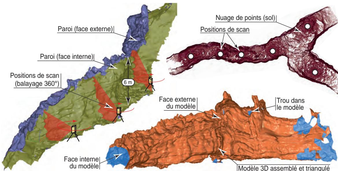
Figure 3 - Procédure de scannerisation 3D sur le terrain par différentes stations successives. Les sphères servent au référencement et à l'assemblage des scènes 3D entre elles. Des logiciels de retro-ingénierie type 3DReshaper sont utilisés pour le maillage et pour l'inspection du modèle. Ici le modèle de Midroï.
