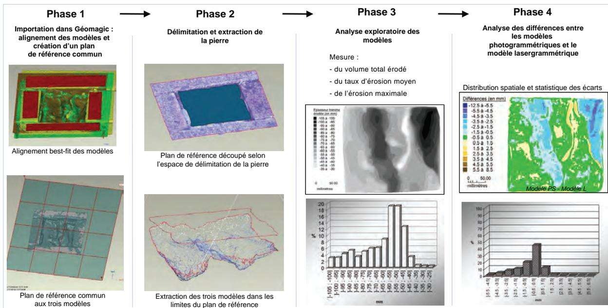
Figure 2 - Phasage du traitement dans Géomagick des nuages de points issus des 3 méthodes d'acquisition.
