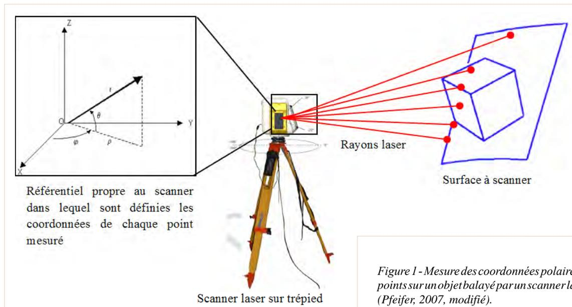
Figure 1 - Mesure des coordonnées polaires (φ, θ, r) des points sur un objet balayé par un scanner laser terrestre (Pfeifer, 2007, modifié).
