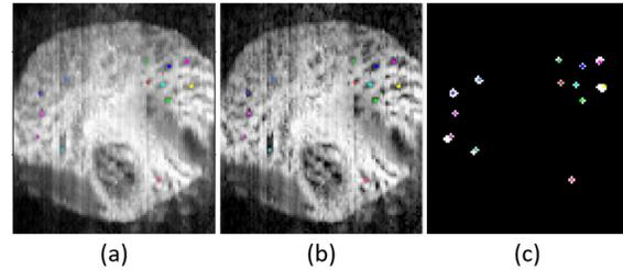
FIGURE 2 – (a) Annotation incomplète des pores. Un pore identifié est marqué d’un point sur l’image *en-face*, en vérifiant la continuité dans les images adjacentes. (b) Image pré-traitée avec des filtres morphologiques pour rehausser les pores. (c) Croissance des régions sur (b) pour générer la vérité terrain.
