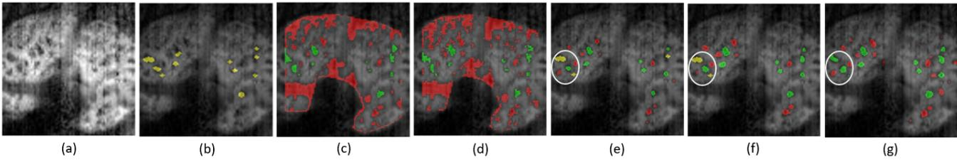
FIGURE 5 – Résultats de segmentation. (a) Image pré-traitée. (b) Vérité terrain. (c) Chan\_Vese [11]. (d) W-Net [12]. (e) U-Net [6]. (f) Attention U-Net [9]. (g) Notre méthode en prenant en compte l’information contextuelle et la fonction de coût adaptée. Les zones vertes, rouges et jaunes sont respectivement les pores correctement détectés, rajoutés et manqués.
