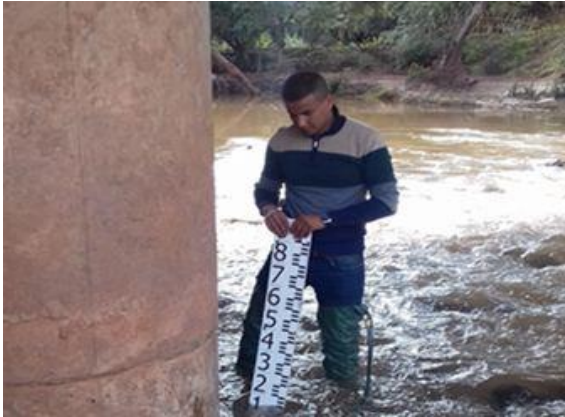
Photo 6 : Installation d'une échelle limnimétrique sur le pont de l'Oued Ouzoud (Benchattou, 2019).
