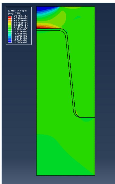
Figure 5 : Contraintes maximales principales au sein de la prothèse
