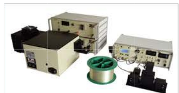
Banc de mesure de transmission sur fibre optique
