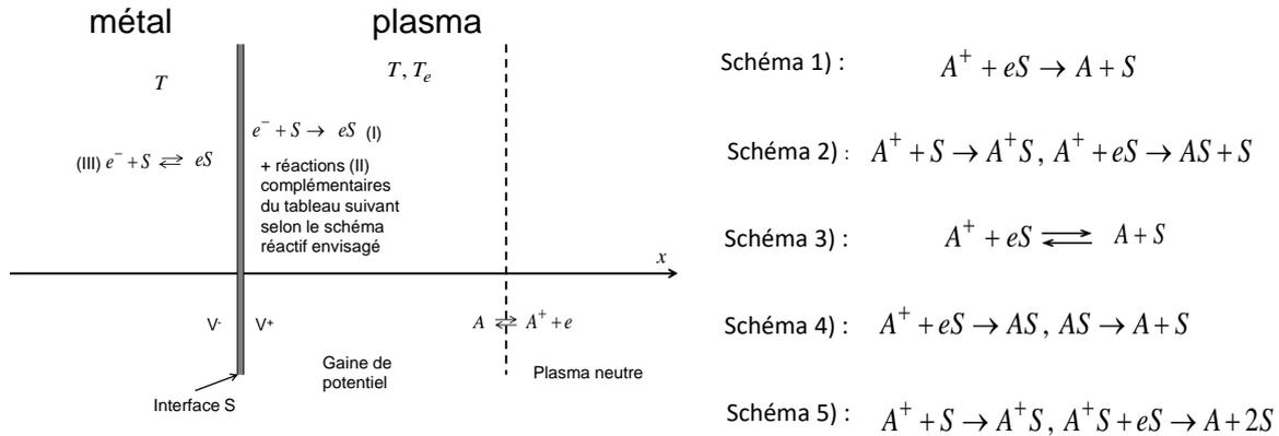
**Figure A4.** Modélisations de l'interface métal-plasma sous basse pression envisagée dans l'étude d'une sonde de Langmuir.
