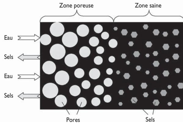
Figure 3 : Vision schématique d'un enrobé bitume partiellement lixivié
