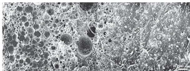
Figure 5: Image obtenue au MEB environnemental d'un enrobé bitume partiellement lixivié après 11 mois de contact avec de l'eau pure
