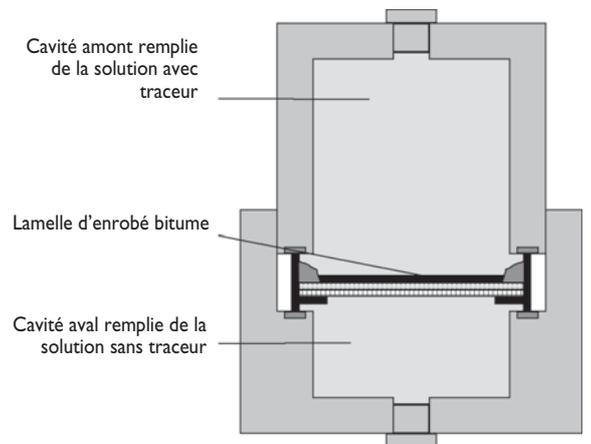
**Figure 9 : Principe de fonctionnement d'une cellule de diffusion**
