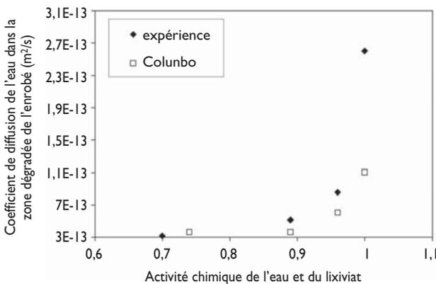
**Figure 10 :** Évolution du coefficient de diffusion de l'eau dans la zone poreuse d'un enrobé bitume en fonction des conditions de dégradation : 1 – d'après les mesures expérimentales 2 – d'après le modèle Colonbo
