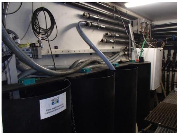
Figure 68 : Point d'alimentation des pilotes en eaux usées brutes de la halle d'essais de la Feyssine.
