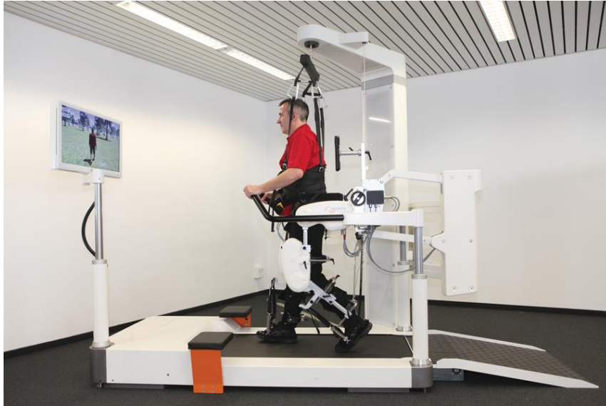
Figure 1. Lokomat@Pro : Illustration d'un robot pour la rééducation de la locomotion : (Picture: Hocoma, Switzerland, http://www.hocoma.com ).
