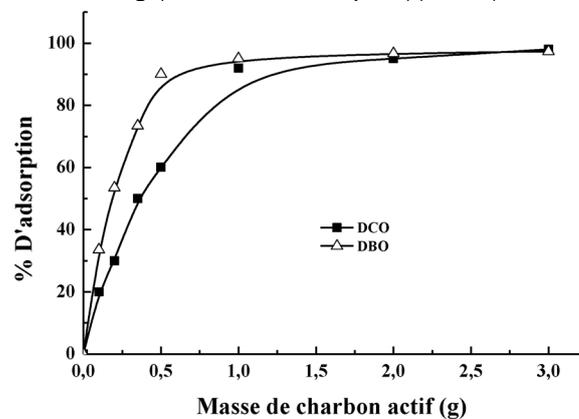
**Figure 2 : Influence du dosage en charbon actif CAK sur l'abattement de la DCO et de la DBO (V = 100 ml, t = 15 h, [DCO]<sub>0</sub> = 75,2 mgO<sub>2</sub>/L, [DBO]<sub>0</sub> = 30,1 mgO<sub>2</sub>/L)**
