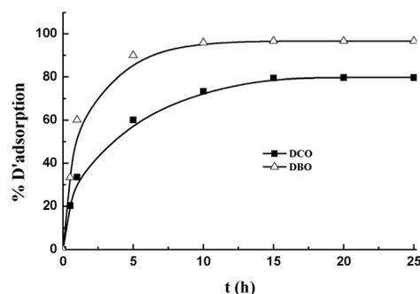
**Figure 1 : Influence du temps de contact sur l'abattement de la DCO et de la DBO par le charbon actif CAK ( $V = 100$  ml,  $m_{CA} = 1$  g,  $[DCO]_0 = 75,2$  mgO<sub>2</sub>/L,  $[DBO]_0 = 30,1$  mgO<sub>2</sub>/L)**
