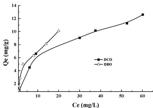
**Figure 3 : Isotherme d'adsorption en terme de la DCO et de la DBO ( $V = 100$  ml,  $[DCO]_0 = 75,2$  mgO<sub>2</sub>/L,  $[DBO]_0 = 30,1$  mgO<sub>2</sub>/L,  $t = 15$  h)**
