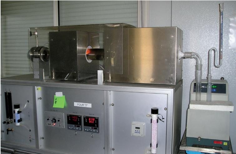
**Figure 2 – Four à combustion utilisé en laboratoire pour l'analyse du tritium.**
