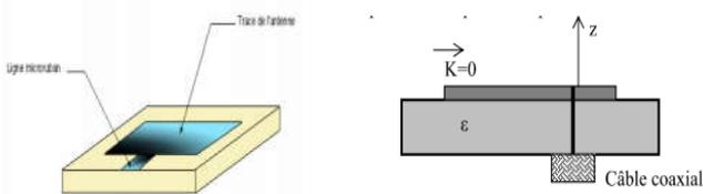
Lorsqu'une antenne est excitée par une ligne microstrip ou via un autre mode d'alimentation, ceci génère des charges négatives autour du point d'alimentation et des charges positives de l'autre partie de l'élément rayonnant,
