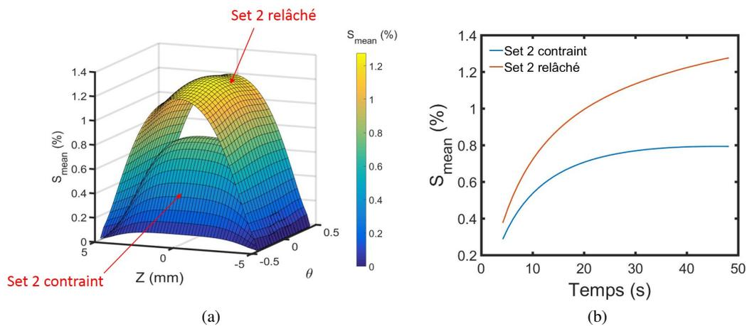
FIGURE 7 – Comparaison de la sensibilité moyenne entre le calcul entièrement contraint et le calcul partiellement relâché pour l'essai 2. (a) Surface de sensibilité moyenne à  $t = 48s$ ; (b) Évolution temporelle de la sensibilité moyenne au centre de la ROI
