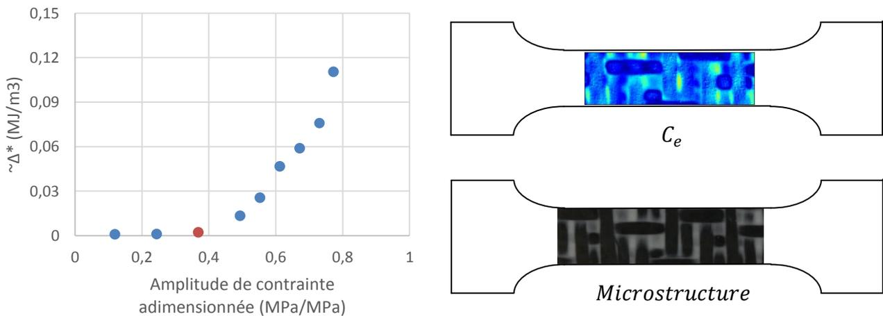
Fig. 3 : Illustration d'une cartographie de couplage thermoélastique en parallèle avec la microstructure dans la zone observée
