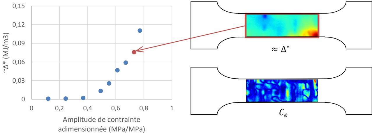
Fig. 2: Illustration de la génération d'une courbe d'auto-échauffement
