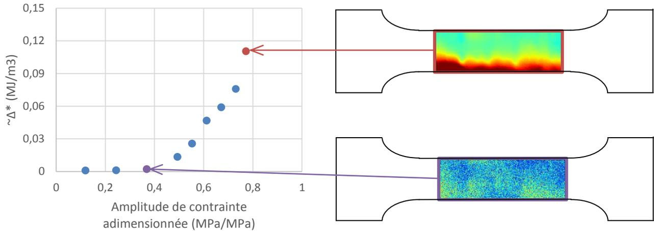
Fig. 4 : Illustration des cartographies d'énergie dissipée
