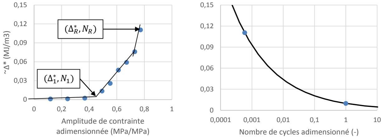
Fig. 5 : Illustration de l'identification du critère énergétique
