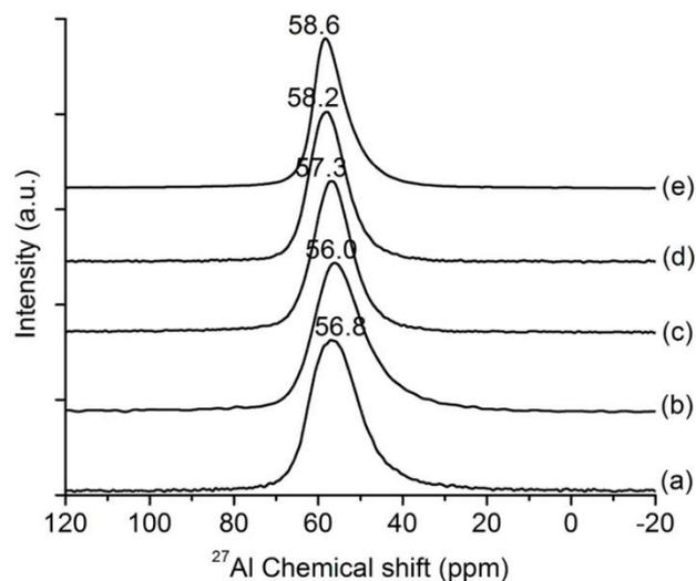
**Figure 6.** <sup>27</sup>Al solid state MAS NMR spectra of samples heated after (a) 15 min, (b) 25 min, (c) 30 min, (d) 60 min and (e) 120 min.
