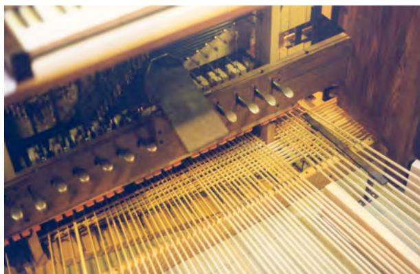
Figure 31: la mécanique de Positif: vergettes en éventail sous le pédalier (photo Jacques Nonnet).
