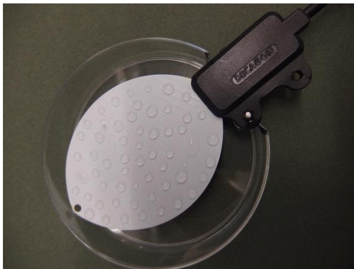
Figure 4. Exemple de rendu d'apport de gouttes d'eau à la surface du capteur LWS à l'aide d'une pipette de précision
