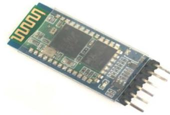
Fig.4. Module Bluetooth HC05 ZS-040
