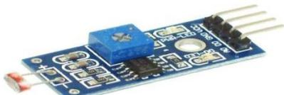
Fig.3. Capteur LDR5516
