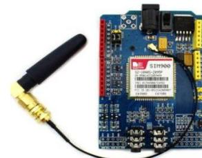
Fig.6. Module GSM SIM900
