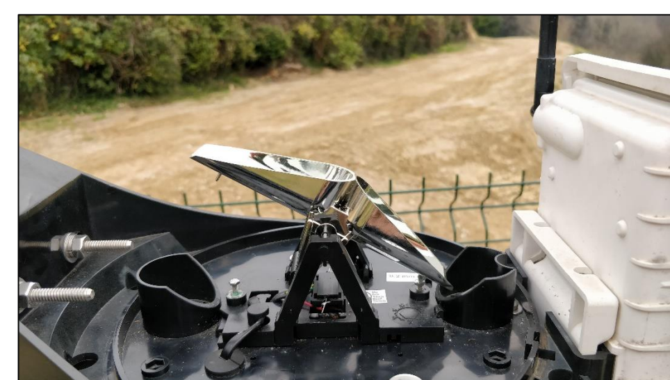
« Davis Instruments » tipping bucket rain gauge
