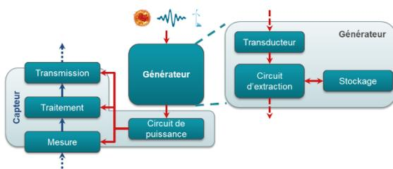
**Figure 3.** Architecture de dispositif de récupération d'énergie
