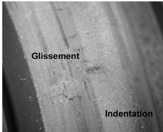
**Fig. 1** Etat de surface de la bague externe après usure par contamination
