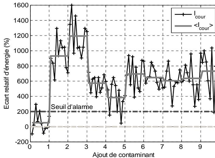
**Fig. 3** Valeurs de  $I_{cour}$  lors de l'usure d'un roulement par contamination
