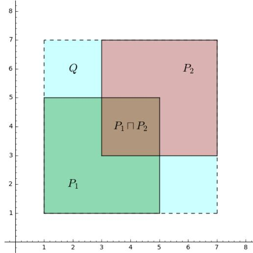
Figure 2: Intersection  $P_1 \cap P_2$  of polyhedra  $P_1 : \{C_1 : x \geq 1, C_2 : x \leq 5, C_3 : y \geq 1, C_4 : y \leq 5\}$  and  $P_2 : \{C'_1 : x \geq 3, C'_2 : x \leq 7, C'_3 : y \geq 3, C'_4 : y \leq 7\}$ .
