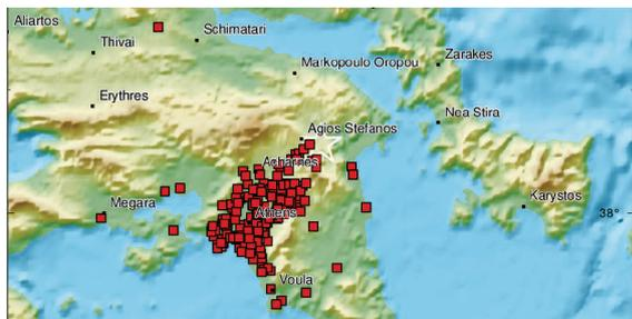
**Figure 3.** Localisation des utilisateurs ayant lancé l'application LastQuake (carrés rouge) dans les 60s suivant le séisme du 15 janvier 2018 de M4.3 à proximité Athènes (Grèce). La localisation sismique du séisme (étoile blanche) a été disponible après 292s alors que la détection à partir des seuls lancements de l'application était réalisée en 24s.
