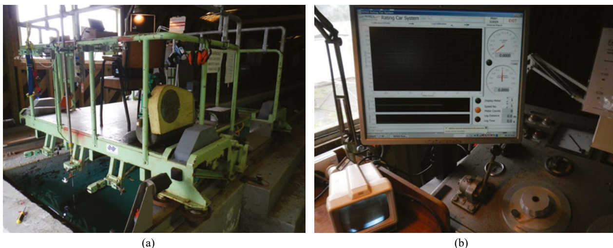
Figure 4 : Bassin national d'étalonnage des courantomètres du NIWA, situé au nord de Christchurch : (a) le chariot pouvant emporter jusqu'à trois équipages mobiles ; (b) le poste de pilotage avec visualisation des mesures.
