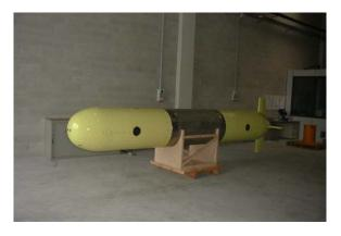
Fig.6 Robot sottomarino antartico autonomo (SARA)
