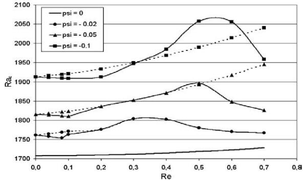
Fig. 4.  $Ra_C = f(Re)$  pour  $\Psi < 0$  et  $Re < 1$ .  $Le = 100$  et  $Pr = 10$ . Lignes pointillées : ondes progressives allant dans le sens de l'écoulement, lignes pleines : ondes progressives allant en sens contraire de l'écoulement.
