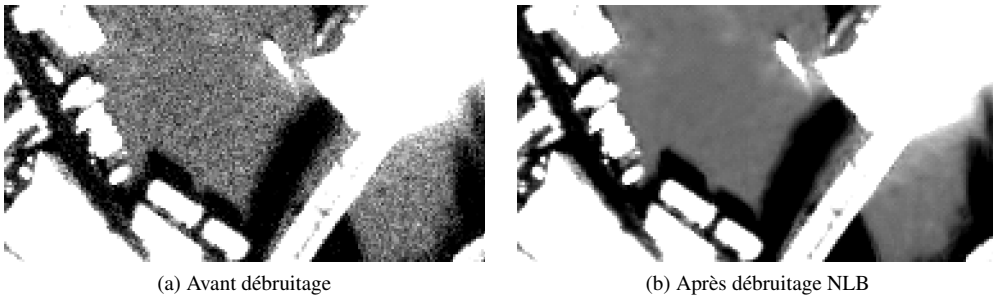
FIGURE 1 – Illustration de l'impact du débruitage NLB sur une image panchromatique Pléiades 1A au dessus de Venise, Italie.
