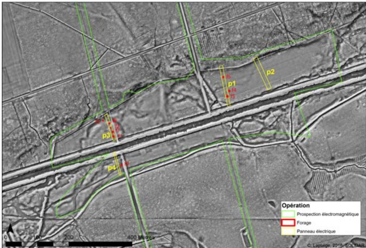
Figure 17. Localisation des interventions (forage, panneau électrique et mesure de la conductivité) réalisées en 2016 (C. Laplaige, 2016 © SOLIDAR)
