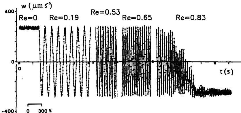
FIG. 7. Evolution de la vitesse verticale  $W(t)$  pour  $Ra = 2420$  et différents  $Re$ . Transition  $R_{\perp}$  de convection naturelle vers  $R_{\perp}$  en déplacement pour  $Re > 0$  puis vers  $R_{\parallel}$  pour  $Re = 0,83$ .
