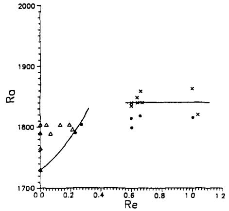
FIG. 9. Représentation dans le plan ( $Ra - Re$ ) des transitions entre un écoulement de Poiseuille ( $\bullet$ ) et une convection sous forme  $R_{\perp}$  ( $\Delta$ ) ou sous forme  $R_{\parallel}$  ( $\times$ ).
