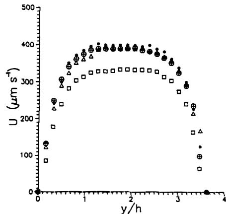
FIG. 16. Vitesse longitudinale  $U_{\parallel}(y/h)$  des  $R_{\parallel}$ . Cas  $Re = 1,02$ : ⊕,  $Ra = 2037$ ; ●,  $Ra = 2429$ ; △,  $Ra = 3494$ . Cas  $Re = 0,86$ : □,  $Ra = 2024$ .
