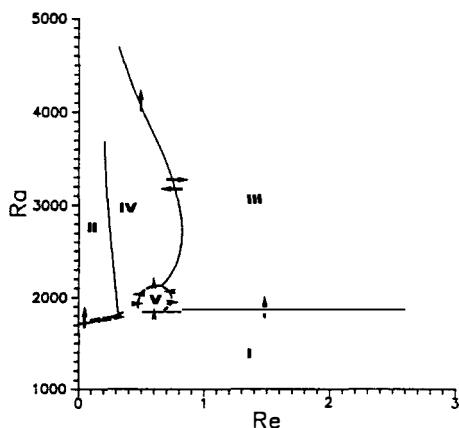
FIG. 18. Transition entre différents types d'écoulements observés. (I) Écoulement de Poiseuille. (II) Structure de type  $R_{\perp}$ . (III) Structure de type  $R_{\parallel}$ . (IV)  $R_{\perp}$  ou  $R_{\parallel}$  suivant les conditions initiales. (V) Superposition de  $R_{\perp}$  et de  $R_{\parallel}$ . Les flèches indiquent le sens des transitions observées.
