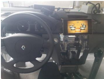
Figure 2 : Dispositif de conduite simulée + écran tactile
