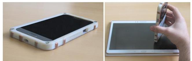
**Figure 1 :** Coque imprimée en 3D (Gauche) et *stacking* du smartphone sur l'écran de la tablette (Droite).
