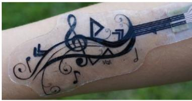
Figure 19: iSkin, capteur tactile pour le corps
