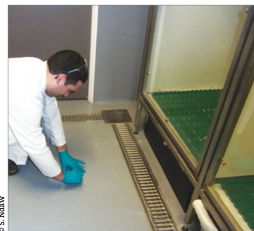
Photo 1. Prélèvement sur le sol du chenil de chimiothérapie sur une surface de 100 cm 2 .
