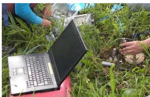
Association de la sonde avec un mini VNA ANRITSU MS46121A connecté via liaison USB à un PC
