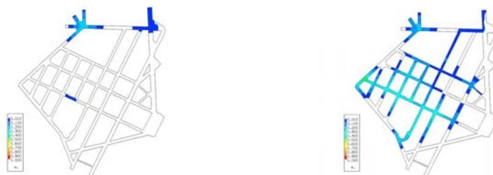
**Fig 8 .** *Submersion des rues au début de la crue (gauche) et après 150 min. (droite).*
