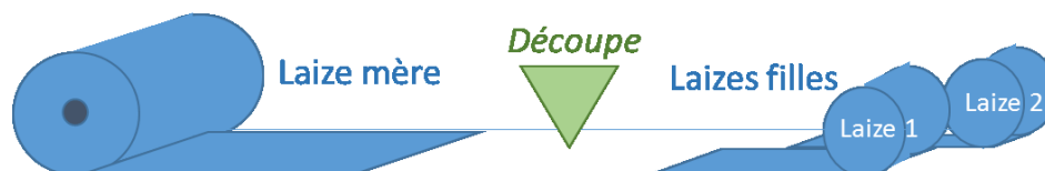
Figure 1 : Modèle de découpe d'une laize mère en plusieurs laizes filles
