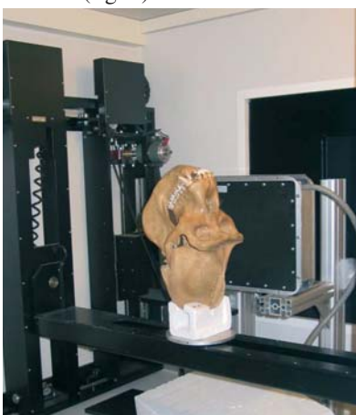
Fig. 5 : Positionnement et acquisition d'un crâne de gorille adulte dans la cabine de microtomographie multi-échelle à rayons X.
