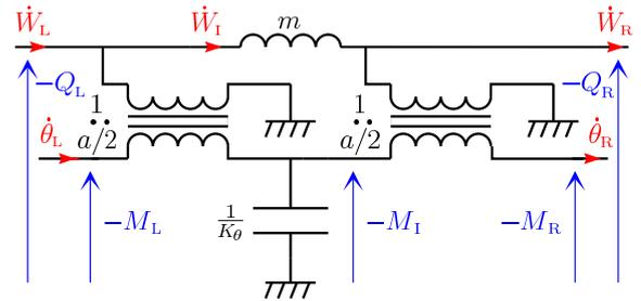
FIGURE 6 – Analogue électrique d'une portion de poutre.
