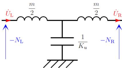
FIGURE 2 – Analogie électrique d'une portion de barre.
