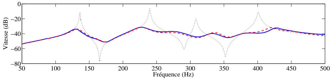
FIGURE 11 – Fonctions de réponse en fréquence pour la vitesse transversale de la plaque - ( $\cdots$ ) réponse expérimentale sans contrôle, ( $\text{—}$ ) réponse expérimentale avec contrôle analogue, ( $\text{--}$ ) réponse simulée avec contrôle analogue.
