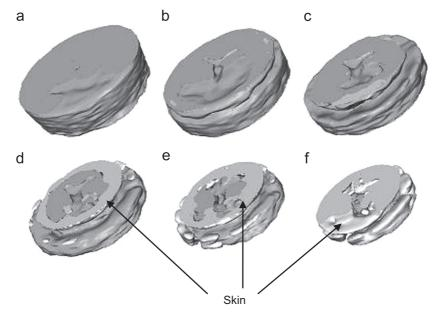
**Fig. 10.** Evolution of the skin formation during convective drying [34]. (a) t 0 min, (b) t 15 min, (c) t 34 min, (d) t 64 min, (e) t 94 min and (f) t 154 min.
